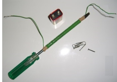
Doma vyrobený elektromagnet
