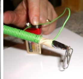
Doma vyrobený elektromagnet
