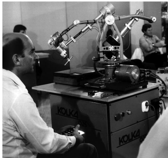
Kolka 025, prvý čl. robot s mikroprocesorovým riadiacim systémom
