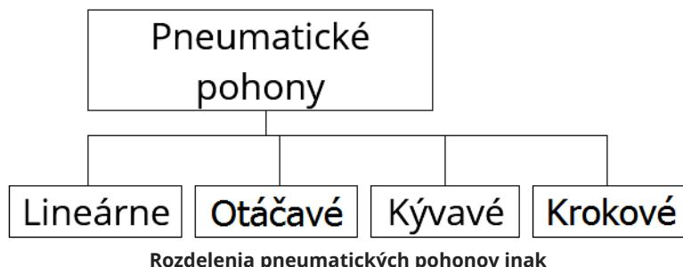
Rozdelenia pneumatických pohonov inak
