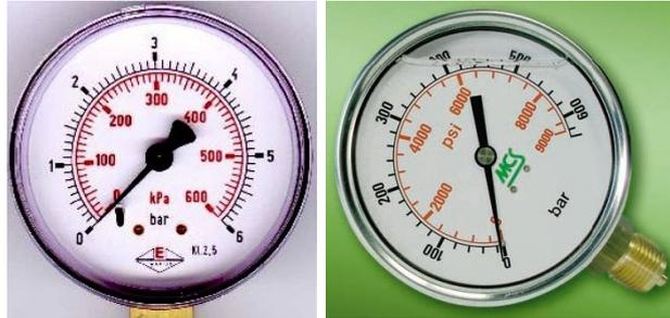
Manometre na meranie tlaku plynu a kvapaliny
