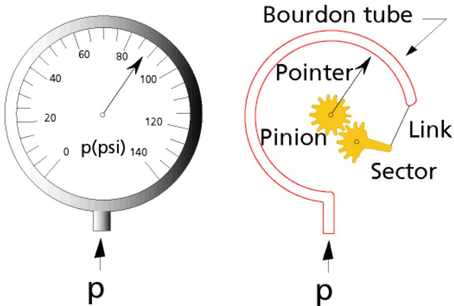
Konštrukčná schéma deformačného manometra s Bourdonovou trubicou v tvare písmena C
