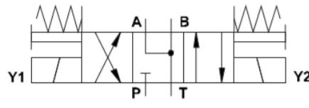
4/3-cestný ventil elektricky a ručne ovládaný, so stredovou polohou pod tlakom
