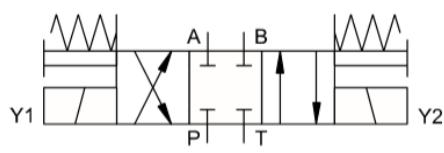
4/3-cestný ventil elektricky a ručne ovládaný, v strednej polohe prípojky odľahčené
