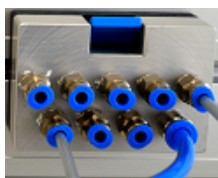
Použitie jednosmerných ventilov v rozvodnej kočke
