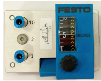
3/2-cestný oneskorovací ventil v základnej polohe zatvorený NC
