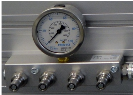
Rozvodná kocka s manometrom
