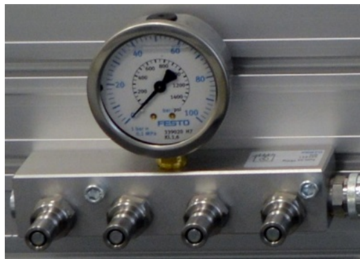
Rozvodná kocka s manometrom
