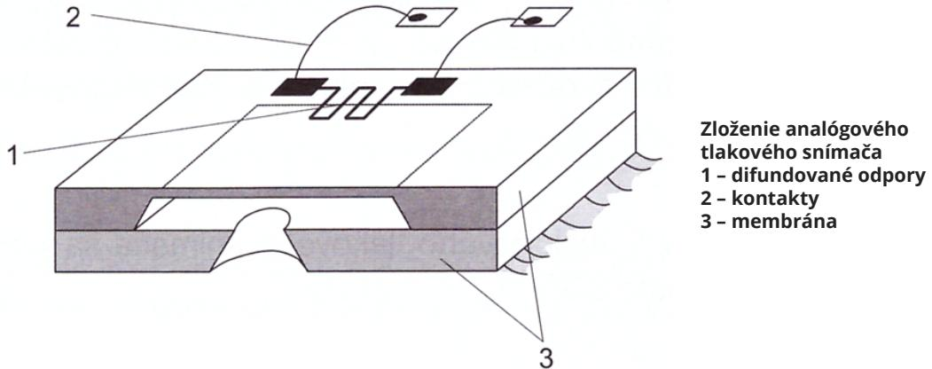
Zloženie analógového tlakového snímača
