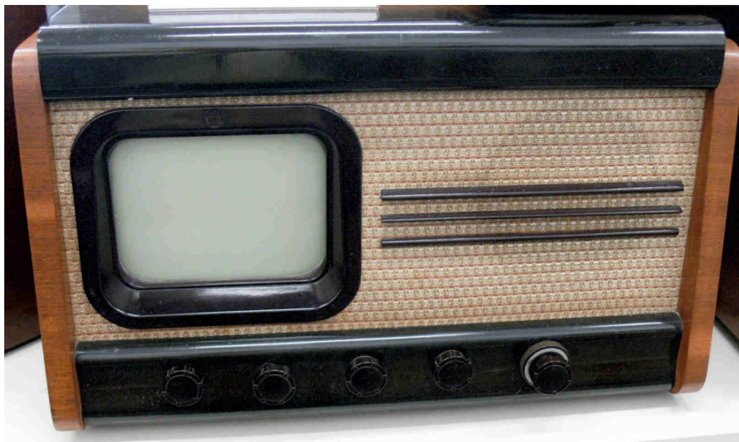
Prvý hromadne vyrábaný československý televízor Tesla 4001A. Vyrábala sa v rokoch 1953-1957, umožňoval príjem jediného, pevne naladeného TV kanálu, a disponoval kruhovou obrazovkou s priemerom 25 cm s obdĺžnikovým bakelitovým rámikom
