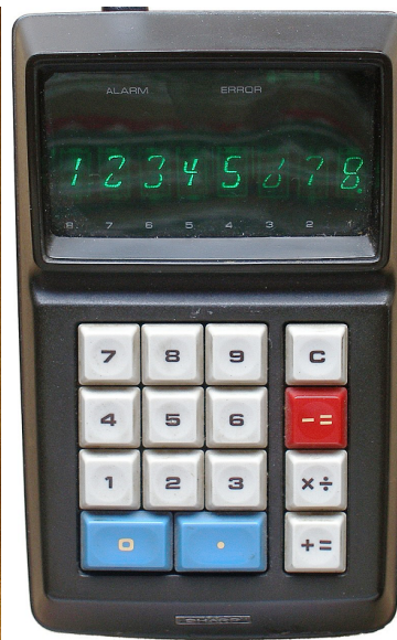
Sharp EL-8, jedna z prvých ručných elektronických hromadne vyrábaných kalkulačiek a súčasne prvá ručná kalkulačka z roku 1970 a 1971
