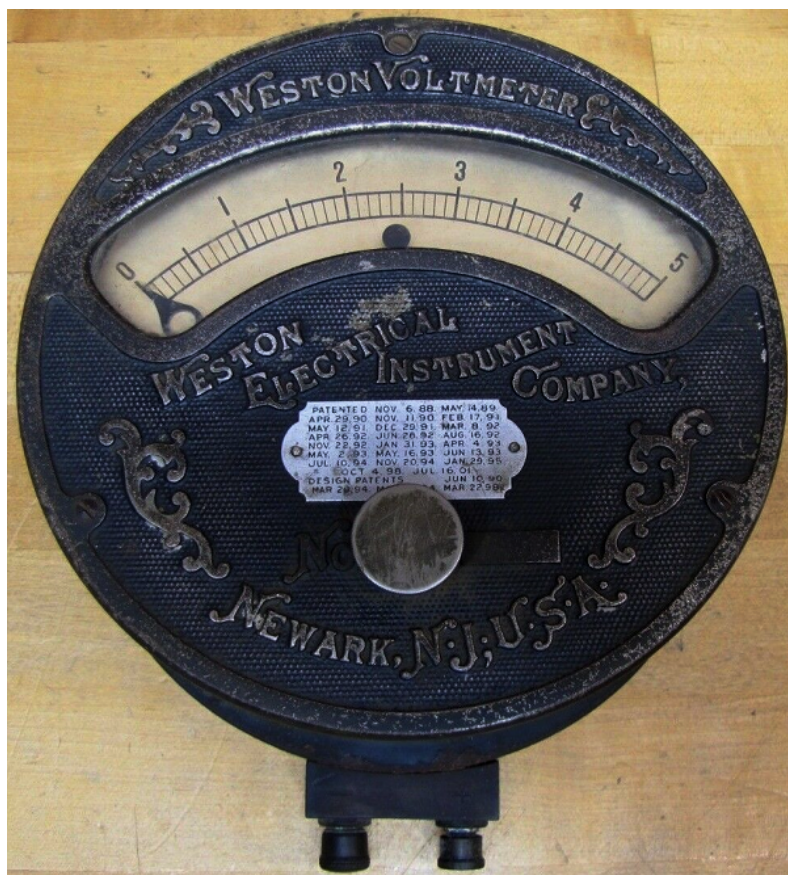
Analogový voltmetre Weston Electric Instruments z roku 1890
