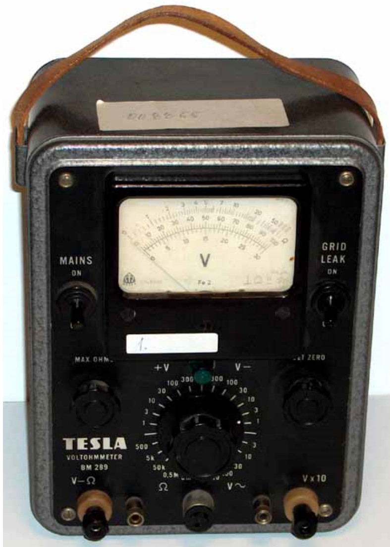
Elektrónkový voltohmmetr Tesla BM 289 z roku 1960
