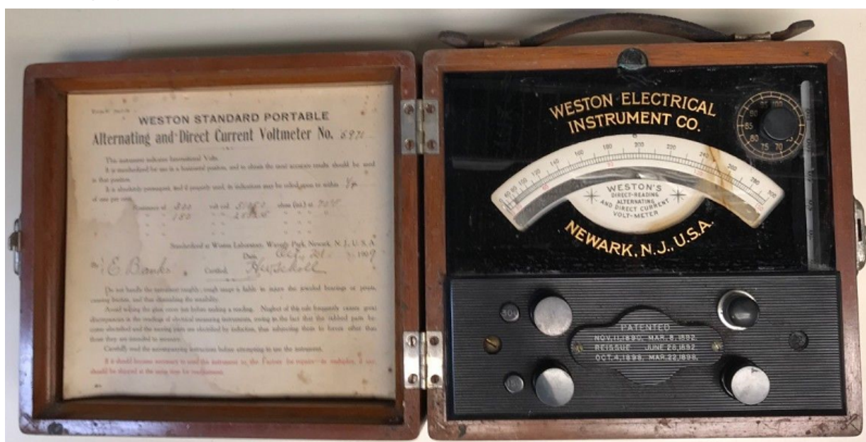
Laboratórny voltmetre Weston Electric Instruments Model 6971 z roku 1909
