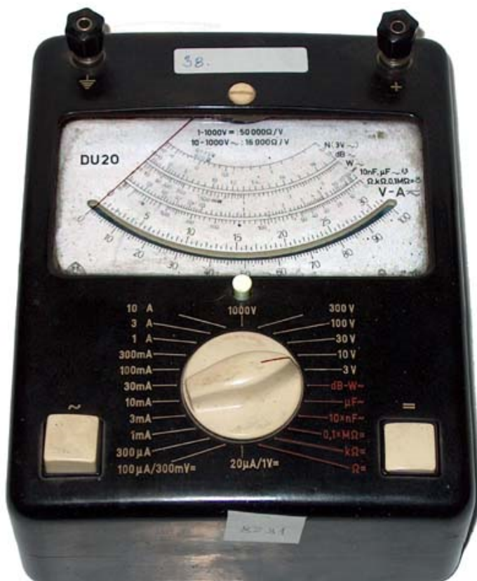
Analógový multimeter Metra DU20
