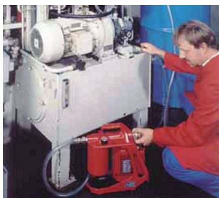
Výmena oleja pomocou olejového filtra
