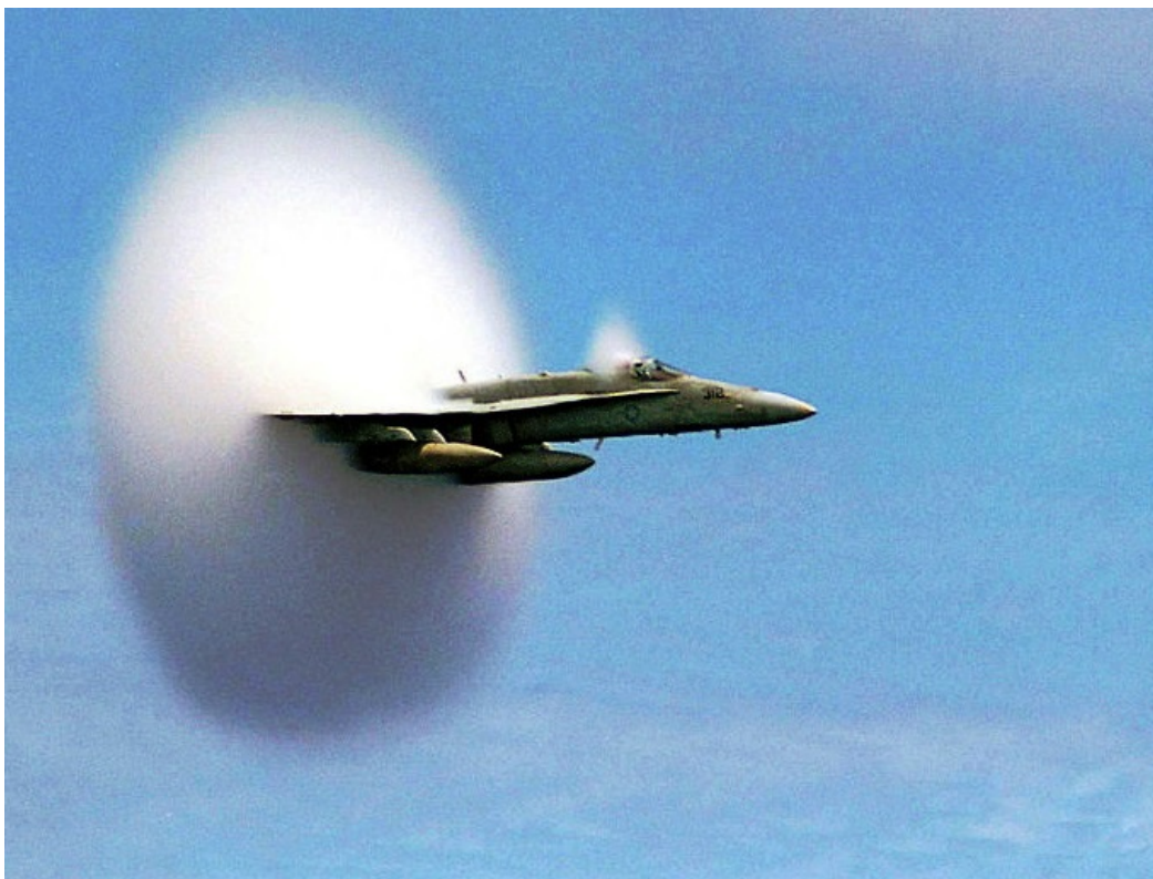
Prekročenie rýchlosti zvuku v podtlaku kondenzuje vlhkosť
