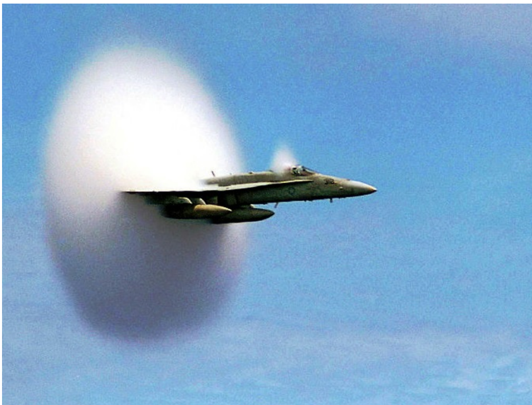
Prekročenie rýchlosti zvuku v podtlaku kondenzuje vlhkosť
