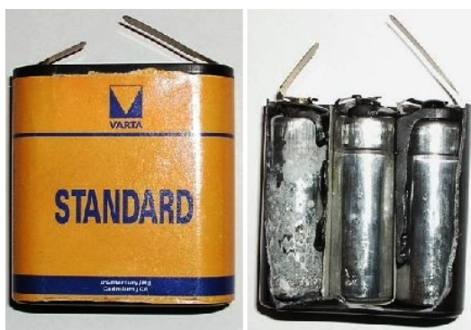
Plochá batéria = tri suché články spojené za sebou
