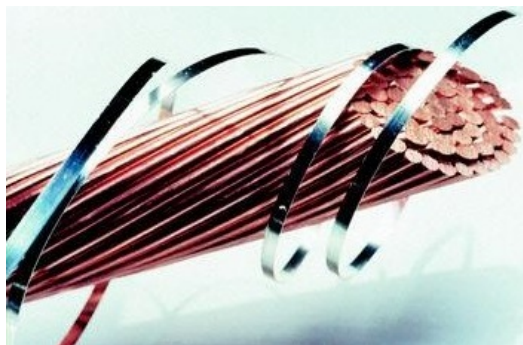
Supravodivý pásik môže viesť rovnaký prúd ako medený kábel 100x väčšieho prierezu
