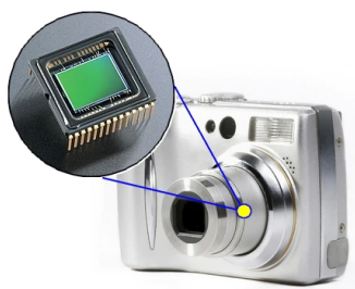
Obrazový čip digitálneho fotoaparátu Snímač reagujúci na pohyb
