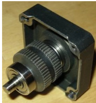
Rotor krokového motora
