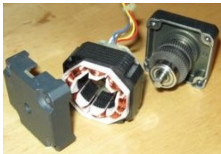
Zloženie krokového motora
