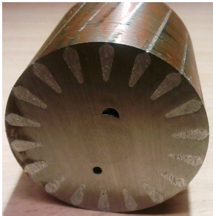
Obr. 5 Rez rotorom (kotva nakrátko)
