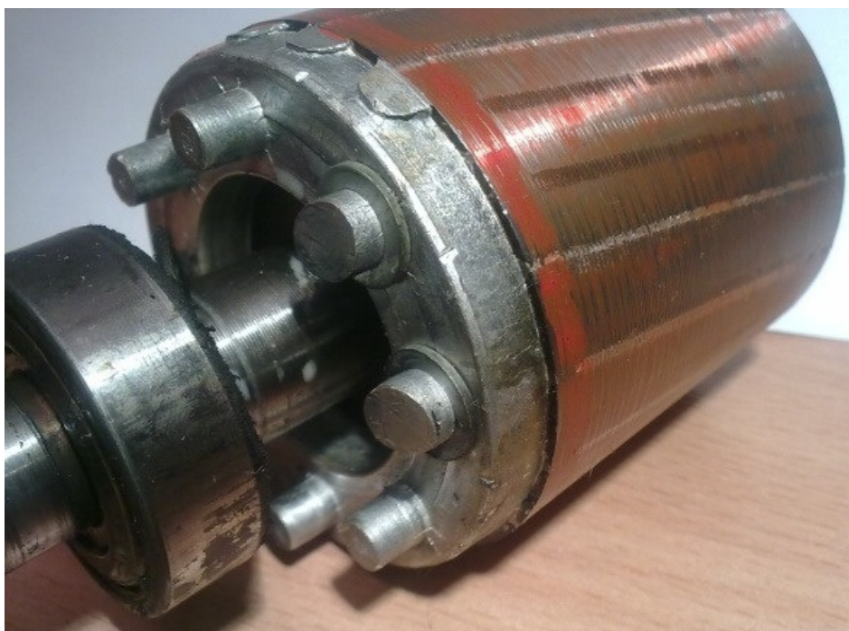
Obr. 6 Detail rotora (vo výreze jedna drážka z hliníka)
