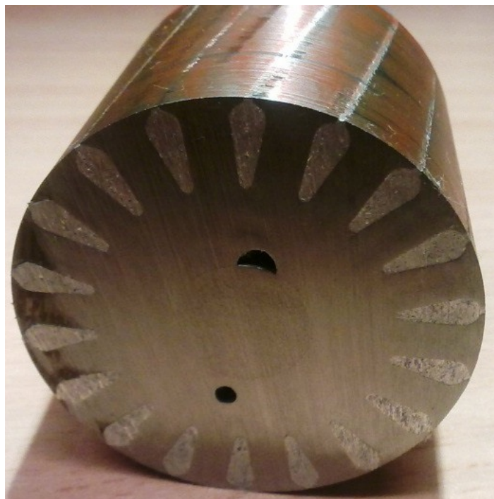
Obr. 5 Rez rotorom (kotva nakrátko)
