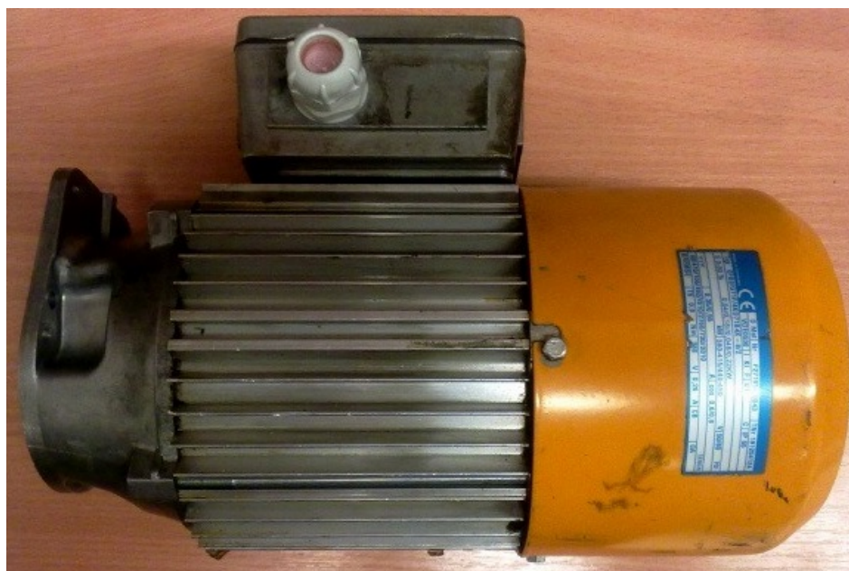
Obr. 29 Dvojrýchlostný motor s brzdou (treťou, elektromagneticky ovládanou)
