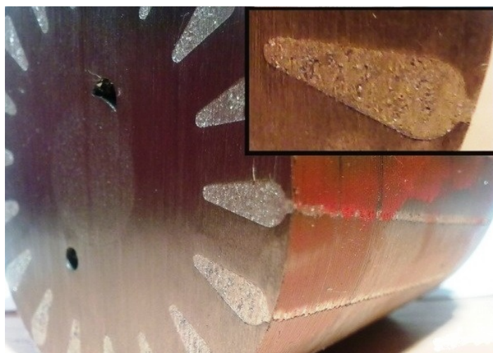
Obr. 6 Detail rotora (vo výreze jedna drážka z hliníka)
