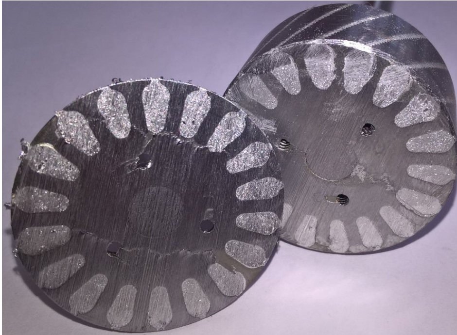
Obr. 43 Rotor je konštrukčne zhodný s trojfázovým motorom s kotvou nakrátko
