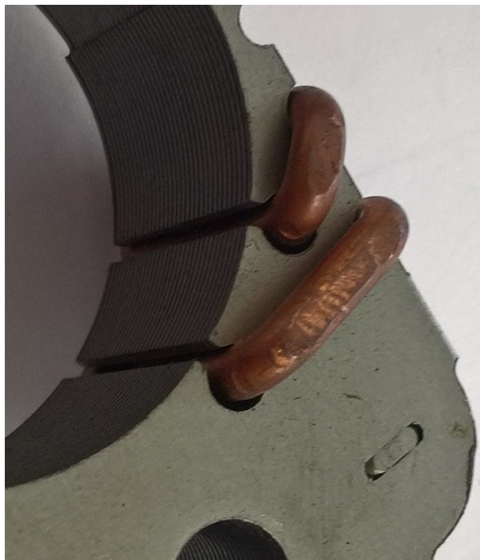
Obr. 41 Detail tieneného pólu
