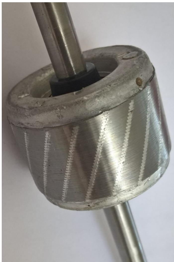
Obr. 42 Rotor je konštrukčne zhodný s trojfázovým motorom s kotvou nakrátko
