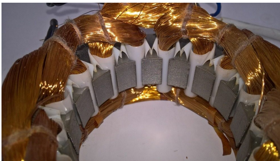
Obr. 38 Konštrukcia statora viacrýchlostného motora s runtime kondenzátorom (z ventilátora)
