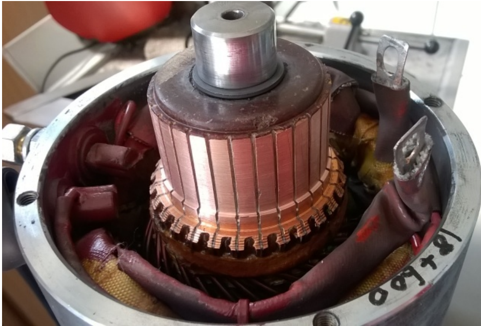
Obr. 51 Komutátor jednosmerného motora. Konštrukčne je takmer zhodný so striedavým
