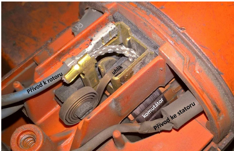
Obr. 49 Detail pripojenia motora. Na obrázku možno vidieť prívody na stator a rotor, komutátor a uhlík
