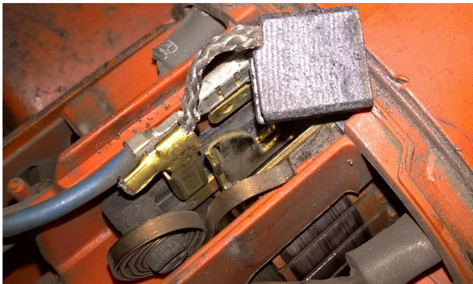
Obr. 49 Detail pripojenia motora. Na obrázku možno vidieť prívody na stator a rotor, komutátor a uhlík
