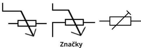
Súčiastky s nastaviteľnou veľkosťou odporu používané v elektrických obvodoch na reguláciu prúdu a napäťa.
