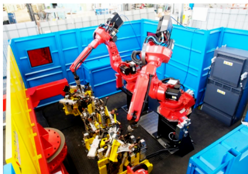
Priemyslové roboty zabezpečené oplatením
