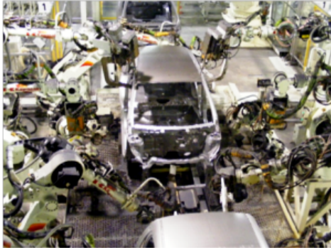
Konvenčné zváracie roboty v automobilke TCPA v Kolíne
