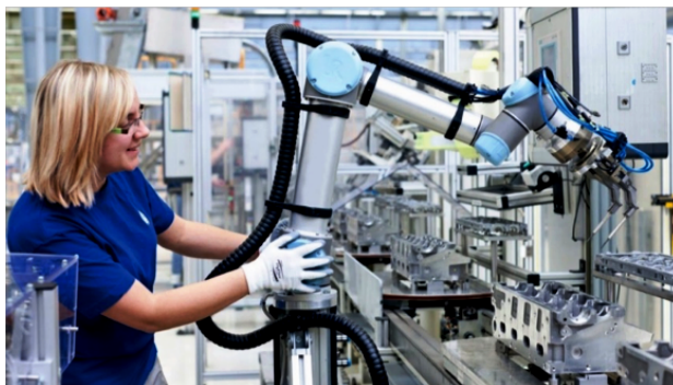
Kolaboratívny robot spoločnosti Universal Robots
