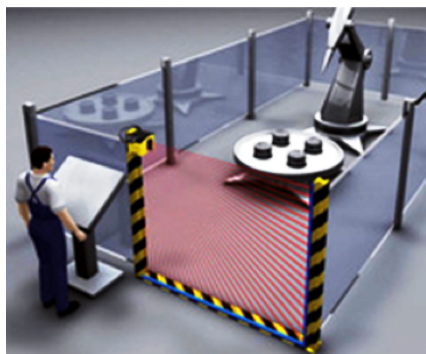
Oplatenie priemyslového robota kombinované s optickou závorou
