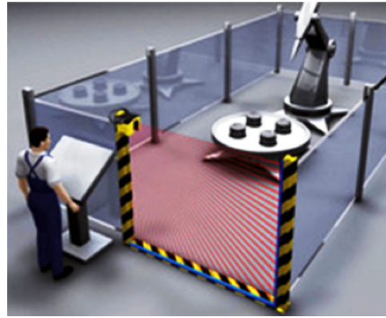
Oplatenie priemyslového robota kombinované s optickou závorou
