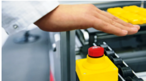
Elektrické núdzové tlačidlo
