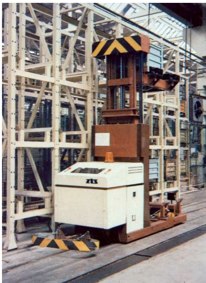
Obr. Mobilný robotizovaný skladovací systém
