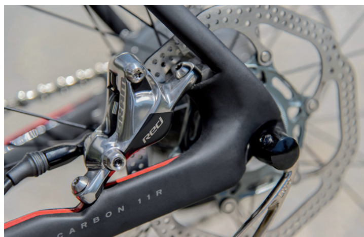
Obr. 132 Hydraulická kotúčová brzda na bicykli
