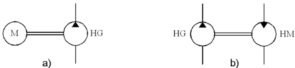
Obr. 31 Prenosový systém s tuhým nositeľom energie:
