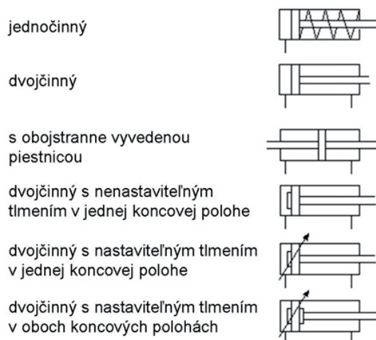
Obr. 79 Schematické značky lineárnych hydromotorov
