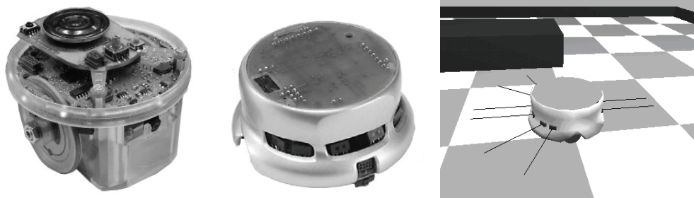
Obr. 14. Robot e-puck (vľavo), Khepera II (v strede) a simulácia robota Khepera II v simulátore Webots (vpravo).
