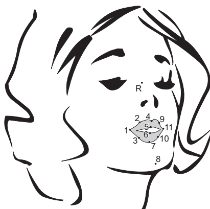
Obr. 2. Zobrazení rozmístění řídicích bodů prvního korpusu pro audiovizuální syntézu řeči. Body 1–4, 7, 9–11 reprezentují vnější konturu rtů, body 5, 6 udávají výšku otevřených úst a výšku horního a dolního rtu, bod 8 umístěný na středu brady reprezentuje pohyb celé dolní čelisti. R je referenční bod, který kompenzuje pohyby celé hlavy.
