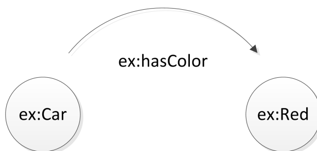
Obr. 1. Vyjadrenie jednoduchého RDF tripletu pomocou grafu.
