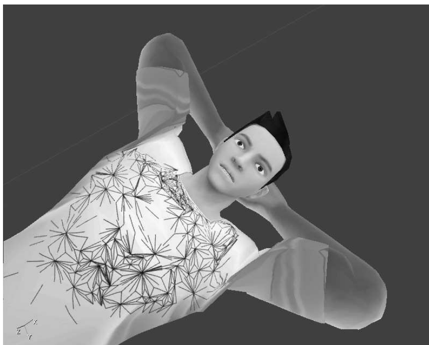
Obr. 4. Špatný „rig“ agenta. Všimněme si, že ramena přiléhají špatně k tělu agenta. V podpaží je tělo jakoby deformované. Toto je důsledek špatného nastavení rigu agenta.
