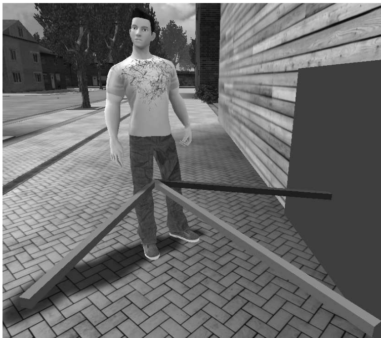
Obr. 12. „Fousy“ virtuálního agenta. „Fous“ vlevo detekuje překážku.
